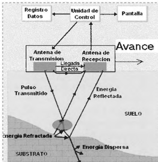
Fig 2. Esquema básico funcionamiento georadar con antena monoestática
