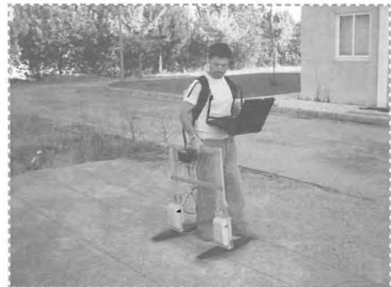
Foto 6 y 7. Toma de perfiles con antena monoestática apantallada. 500MHz. y antena biestática no apantallada. 200MHz
