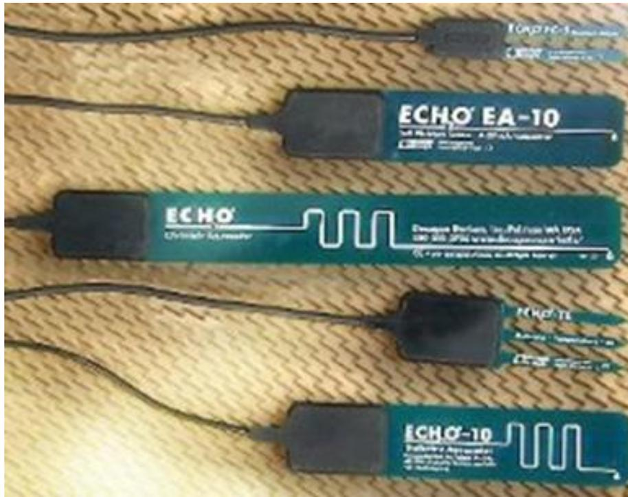
Una varilla emite un impulso de RF y se mira el tiempo al pasar a la otra varilla. Por lo que mide el coeficiente Dieléctrico del suelo a partir del tiempo de recorrido de un pulso electromagnético a lo largo de las varillas de acero. Se pueden colocar, dos, tres o cuatro varillas
