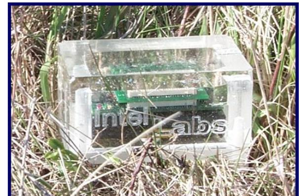
Proyecto ExScal (Extreme Scale) conlleva mas de 1000 nodos sensores de una red inalámbrica de sensores y mas de 200 nodos de comunicación punto a punto para sumideros de información. Para cubrir un área de más de 1,3 kilómetros de distancia por 300m en Florida, EE.UU.
