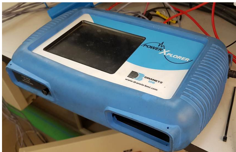
Figura 27. Analizadores de calidad de suministro Dranetz PX-5.
