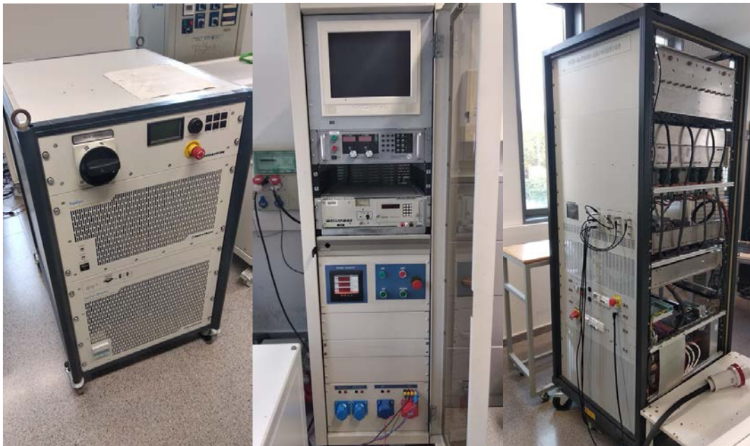
Fuente Regatron de 32kW; Fuente 3kW Magna Power y fuente controlable AC 15kW – Amplificador lineal Puissance Plus 21kW
