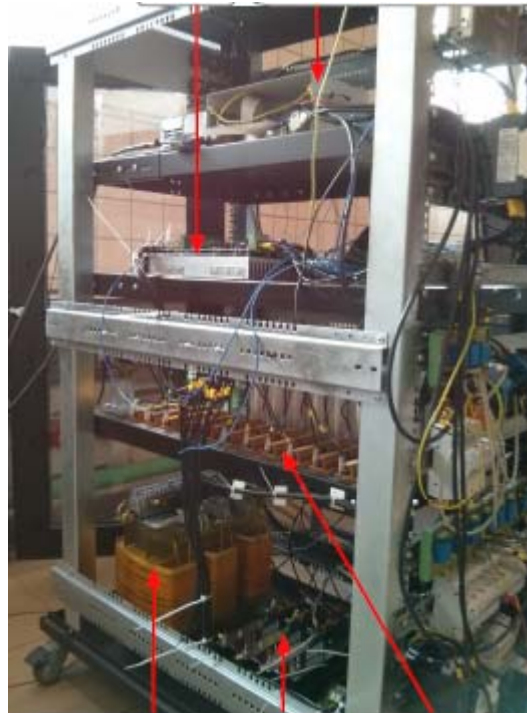
Figura 12. Enlace de alterna basado en Vector Switching Converter (VeSC) para mallado de la red de distribución (400 V, 30 kVA).
