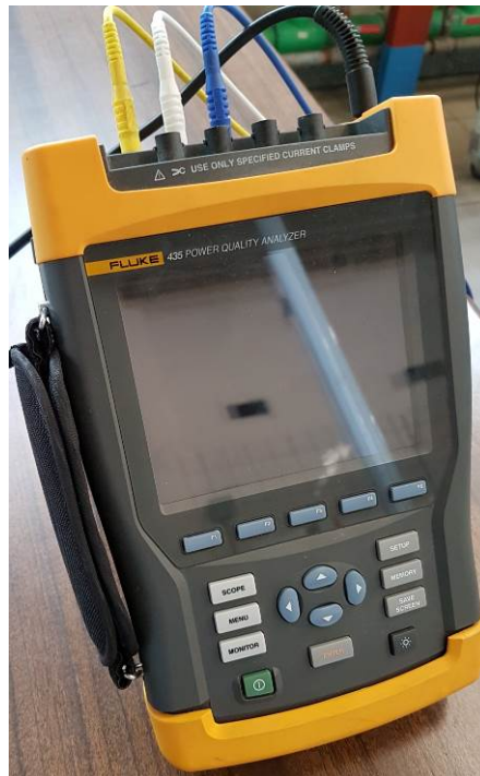
Figura 28. Analizador de la energía y de la calidad de la energía Fluke 435.
