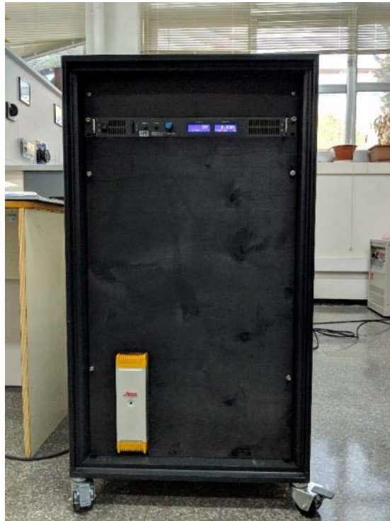
Figura 29. Sistema de emulación de paneles
