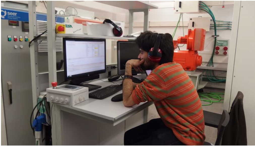
Ensayo de convertidores contra emulador de red
