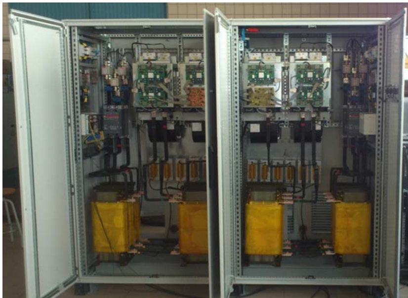
Figura 7: Convertidor en fuente de tensión back-to-back 400 V y 500 kVA.
