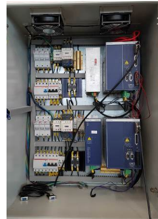
Figura 14: Bancada de motores de imanes permanentes (flujo axial y radial) con convertidores electrónicos asociados.
