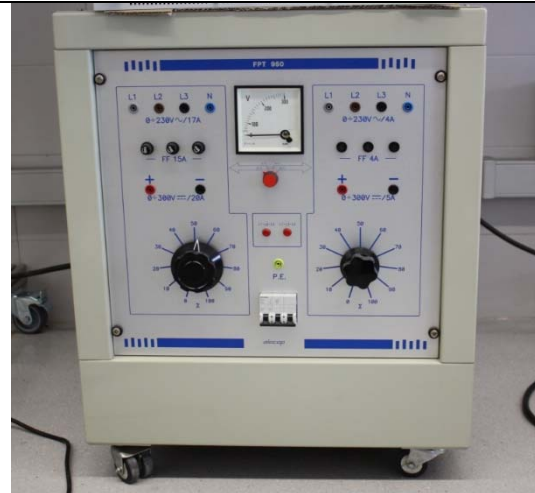
Fuente de DC encargada de la alimentación del circuito de excitación.
