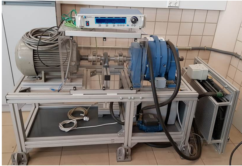
Figura 13: Motor de inducción (400 V, 11.2 kW) con freno de corrientes parásitas.
