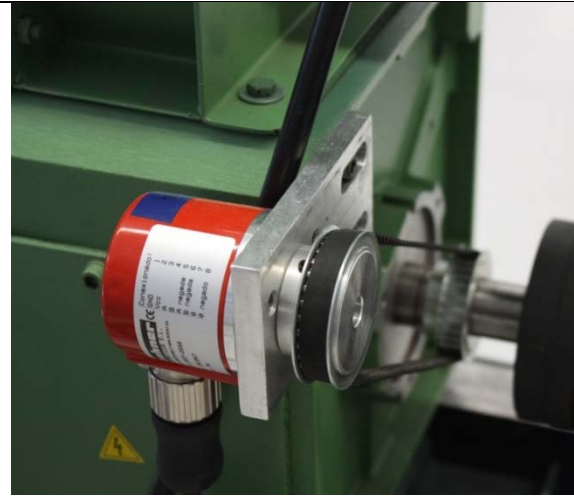
Encoder acoplado al eje de la máquina de DC.
