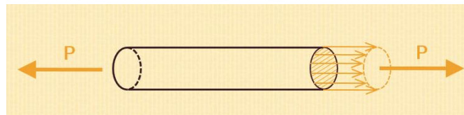
Fig. 2. Barra de sección transversal A sometida a un esfuerzo P y una tensión \sigma
