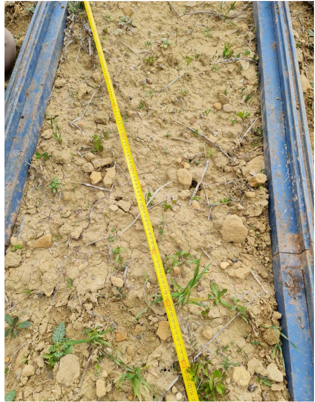
Photo 2. Mesure de L'état de surface du sol selon la méthode des points quadrats. Source : cliché le 25/01/2022.
