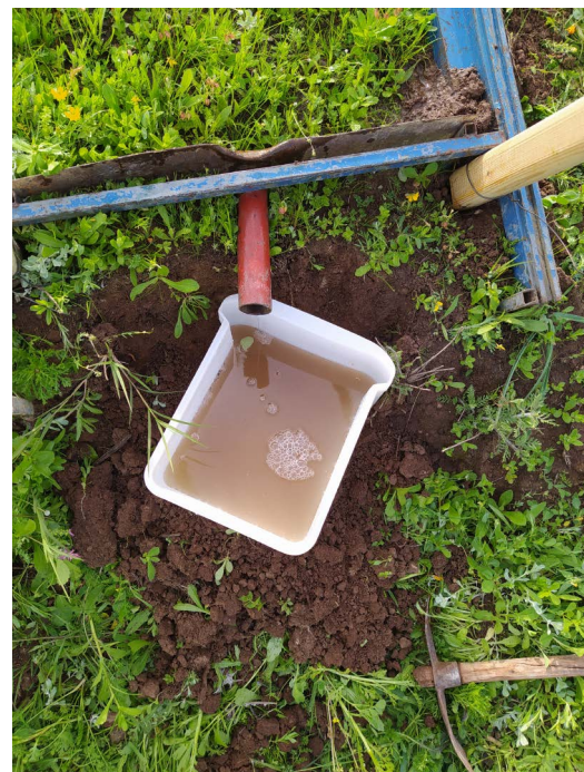
Photo 4. Collecte des eaux de ruissellement pour la quantification de la charge solide. Source : cliché le 17/03/2021.
