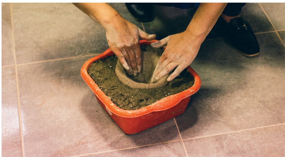
Figura 13. BRB fabricado a partir de un molde excavado en el suelo (Foto: Eloy Taboada-PAMES).
