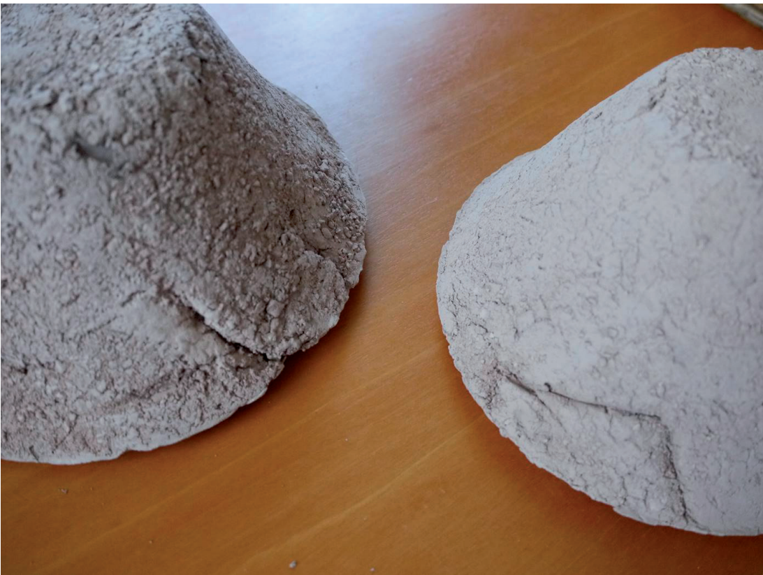
Figura 14. Pliegues en la superficie exterior de BRB elaborados a partir de una torta circular (foto: Juan Luis Montero-PAMES).
