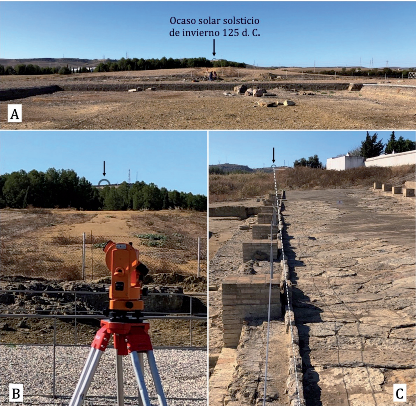
Figura 8. A) Fotografía obtenida desde el extremo oriental del eje del Traianeum . Se muestra la posición del teodolito y la orientación general del edificio hacia el Cerro de la Cabeza de Valencina. También se indica la posición donde se producía el ocaso solar en el solsticio de invierno del año 125 d.C. y el tamaño del disco solar. La zona de tierra más clara justo detrás del teodolito corresponde al decumanus que prolonga el eje del edificio. B) Vista desde la posición del teodolito de dicho decumanus , calle que prolonga hacia poniente el eje longitudinal del Traianeum y enfoca al ocaso solar del solsticio de diciembre. C) Fotografía obtenida desde el puesto de observación 4, en la que se aprecia la alineación de la calle situada al norte del Traianeum con el mismo punto del horizonte. Fotos y composición de C. Esteban López.
