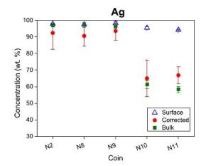
te de cobre, presentando una gruesa capa externa de corrosión donde el cobre se ha perdido (lixivación de cobre), aparentando un enriquecimiento en plata.
