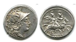
Así por ejemplo, las aleaciones antiguas de plata-cobre se caracterizan por verse afectadas de un aparente enriquecimiento superficial en plata con la consecuente difusión en profundidad hasta varios cientos de micras, mucho más allá de la profundidad de penetración de las técnicas de superficie, por lo cual la composición de la superficie puede no ser representativa
