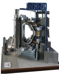
Los reactores del tipo Tokamak (acrónimo ruso de Cámara Toroidal con Bobinas Magnéticas) son los reactores para fusión nuclear más extendidos. De hecho, ITER, el reactor de fusión experimental definitivo que debe demostrar la viabilidad científica y tecnológica de la Fusión Nuclear, está basado en el modelo Tokamak.
