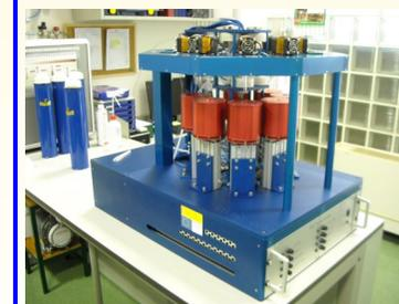
En el CNA, se dispone de un sistema de AMS instalado en el año 2005. El sistema se basa en un acelerador tipo Tandetrón de 1 MV y posee un carrusel con capacidad para 200 muestras. Su diseño le proporciona gran versatilidad, pudiéndose detectar un amplio rango de radioisótopos ( $^{14}\text{C}$ ,  $^{26}\text{Al}$ ,  $^{129}\text{I}$  e isótopos de plutonio). El AMS dispone de 2 laboratorios para la preparación de muestras, el laboratorio de AMS y otro específico para  $^{14}\text{C}$ .
