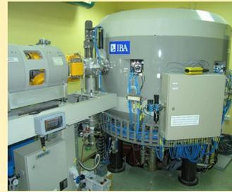
El Ciclotrón fue el segundo acelerador de partículas que se instaló en el Centro Nacional de Aceleradores (año 2004). Este tipo de acelerador consigue acelerar iones en órbitas de radio y energía crecientes mediante la aplicación combinada de un campo eléctrico oscilante y de un campo magnético. Es capaz de acelerar protones y deuterones a 18 y 9 MeV, respectivamente.
