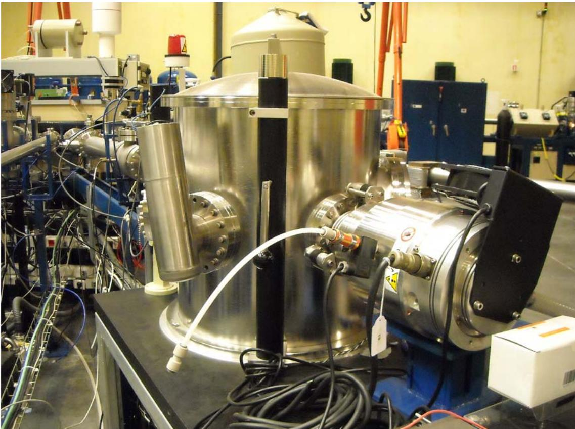
Figura 8: Cámara de Canalización Iónica
