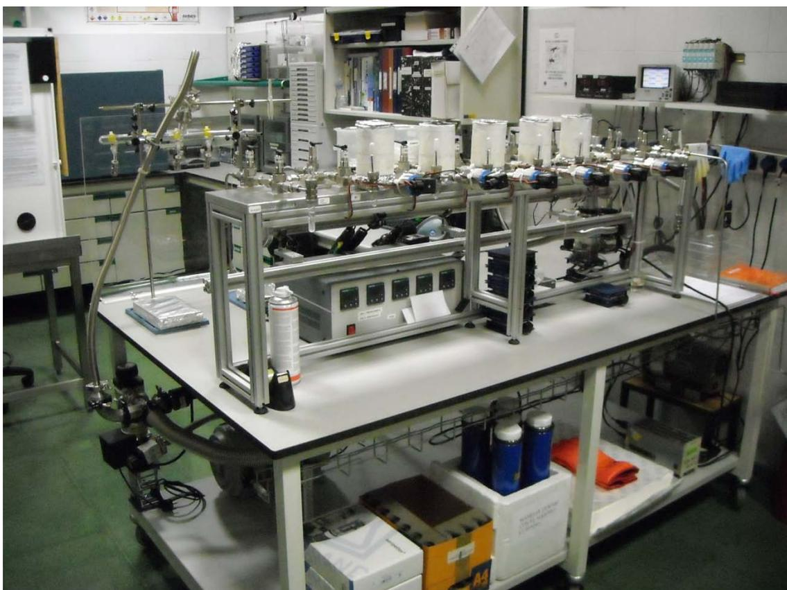
Figura 35: Línea de Grafitización del Laboratorio de Radiocarbono
