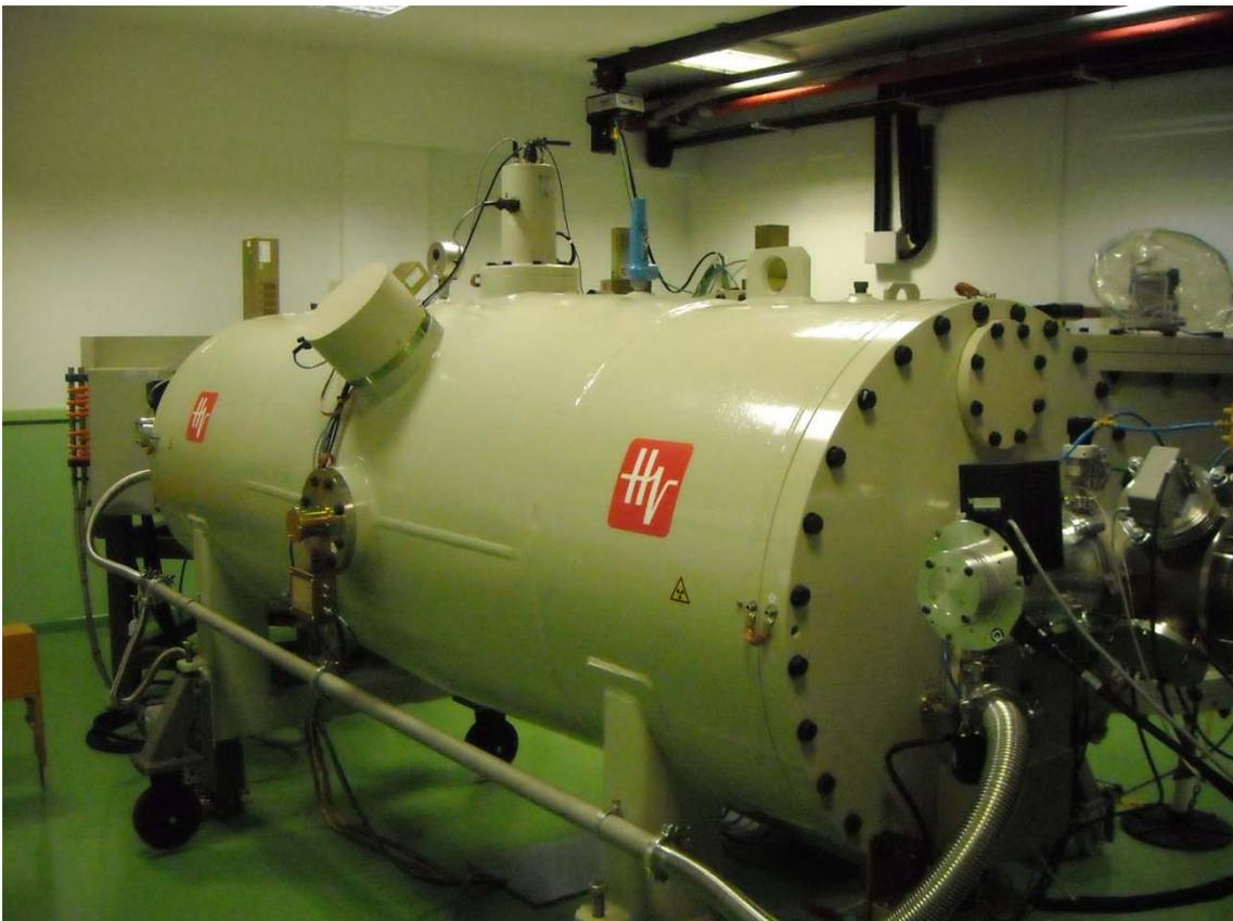
Figura 15: Acelerador Tandetrón de 1 MV
