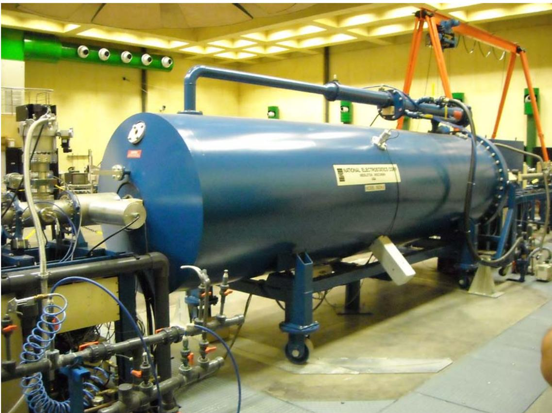
Figura 2: Acelerador Tándem 3 MV
