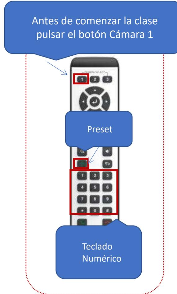
Además se pueden cambiar los enfoques utilizando los atajos de teclado. Por ejemplo: pulsando ALT + 1 se cambia al enfoque 1 (mesa profesor), ALT + 2 al enfoque 2 (Pizarra) y así sucesivamente
